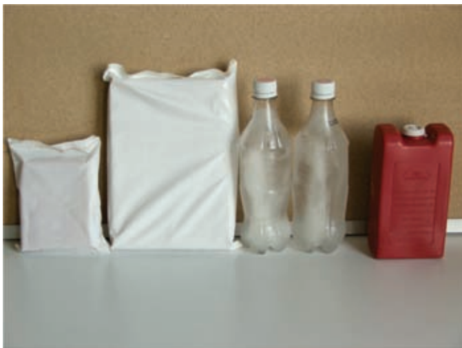
Figura 2 – Alguns tipos de gelo reciclável, disponíveis no comércio, e gelo em garrafas plásticas para conservação da amostra.
