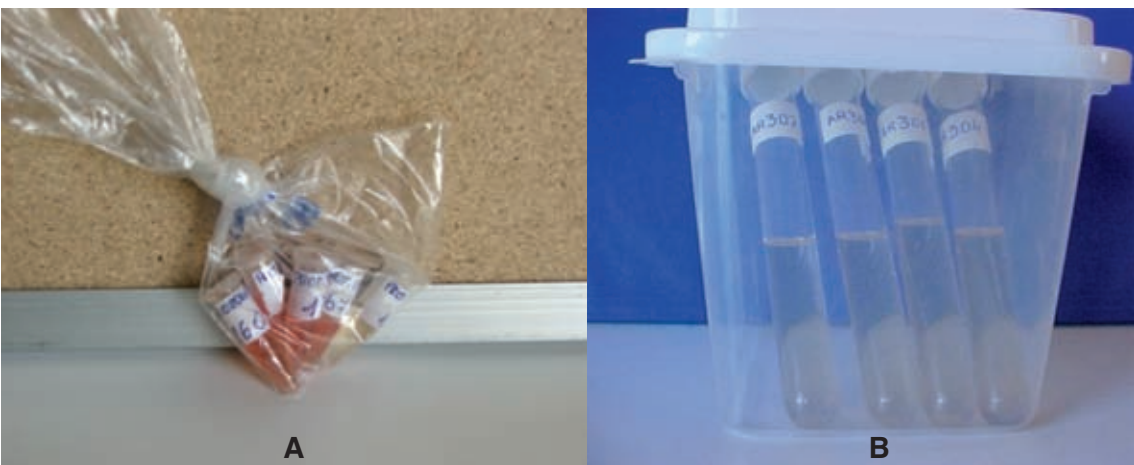
Figura 1 – Tipos de embalagens primárias dentro das secundárias: (A) Tubos tipo “ependorf” dentro de embalagem plástica com nó; (B) Tubos com tampas-rosca, dentro de caixa plástica tampada.
